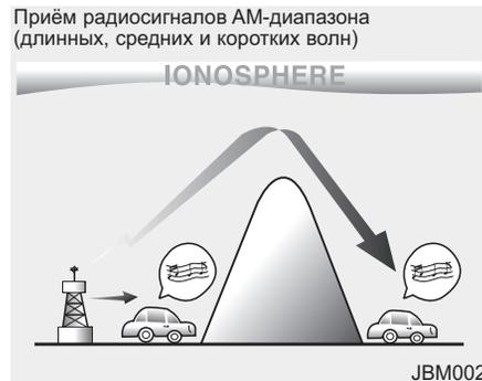
Сигналы AM-диапазона могут приниматься на большем удалении от радиостанции, чем сигналы FM-диапазона. Причина этого - в более низкой частоте радиоволн AM-диапазона. Эти радиосигналы с большой длиной волны и низкой частотой распространяются не по прямой линии в атмосфере, а могут огибать земную поверхность. Кроме того, они огибают препятствующие их распространению объекты, что обеспечивает лучший приём сигнала.
