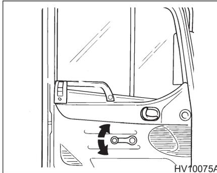
Чтобы поднять или опустить окно, вращайте ручку открытия/закрытия окон по часовой или против часовой стрелки.
