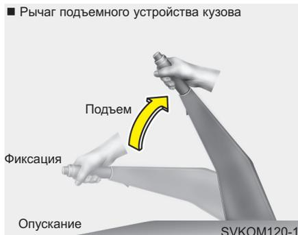
5. Переведите рычаг подъемного устройства кузова в положение "Raise (подъем)".
